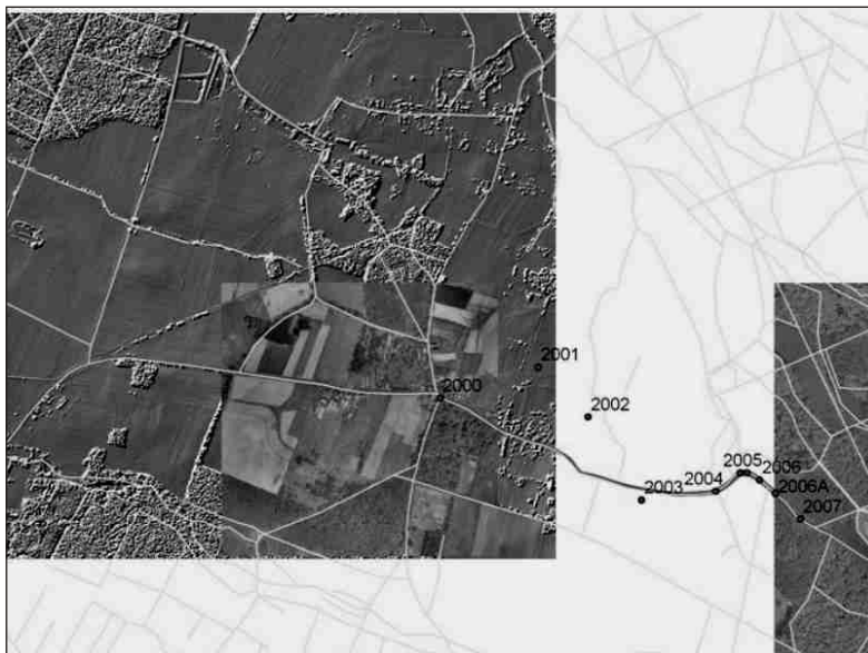
Rys. 4. Kompozycja danych z MMS, ortofotomapy i numerycznego modelu terenu. ródło: Opracowanie własne.
