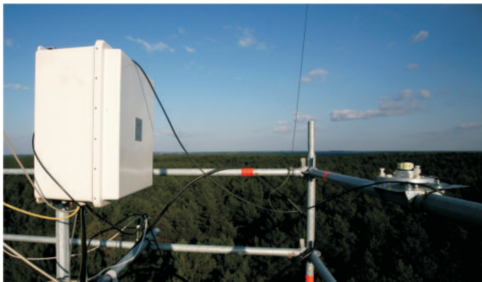
Ryc. 9. Systemy pomiarowe wieży, po prawej – czujnik do promieniowania fotosyntetycznie czynnego (SKP 215, Skye), po lewej – data logger (CR5000, Campbell Scientific). (fot. P. Strzeliński)
