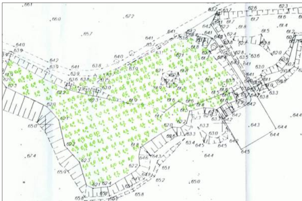
Ryc. 5. Wyniki pomiarów głębokości zbiornika nr 2. źródło: opracowanie własne na podstawie Mapy... 2006
