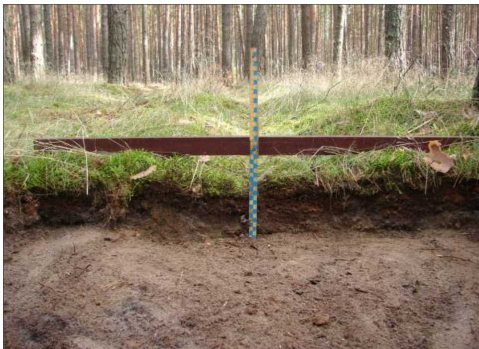
Ryc. 6. Koleina powstała w wyniku przejazdu forwarder
