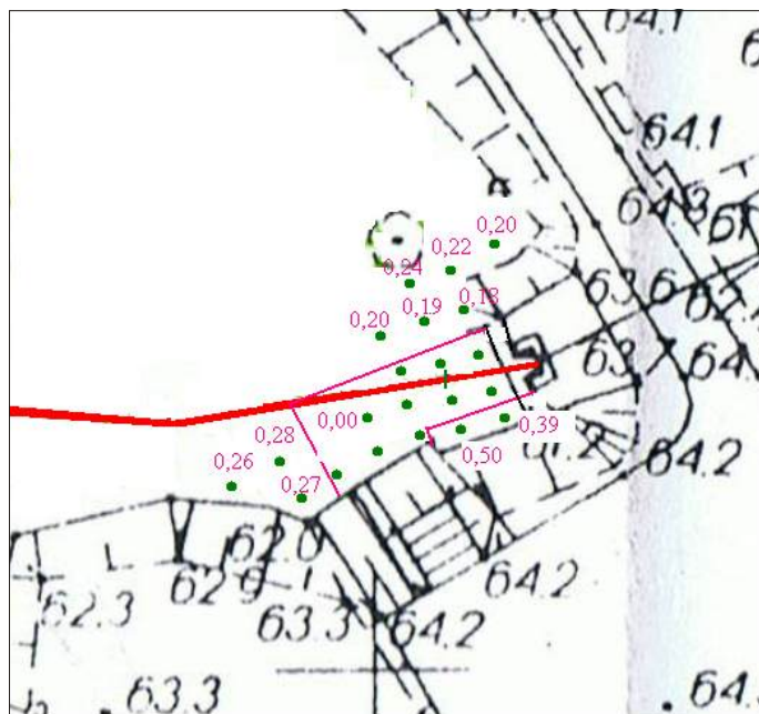
Ryc. 3. Pomiary zamulenia (zielone punkty to miejsca sondowania stopnia zamulenia zbiornika, linia czerwona określa lokalizację koryta pierwotnego cieku).
