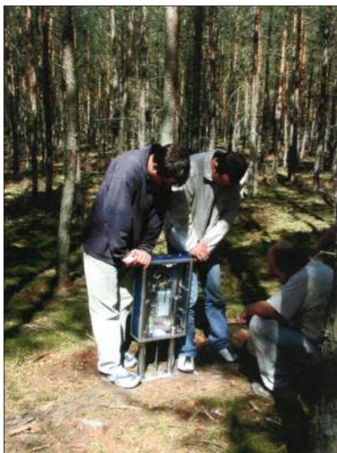
Ryc. 2. Pomiary zagęszczenia gleby w czasie badań
