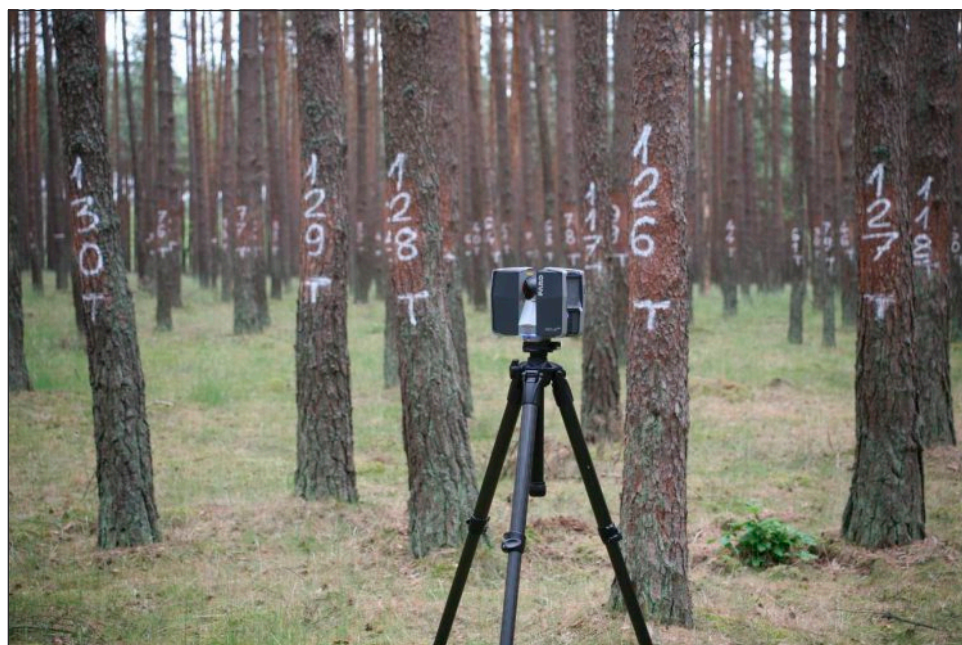
Ryc. 2. Naziemny skaning laserowy powierzchni badawczej w V klasie wieku.
