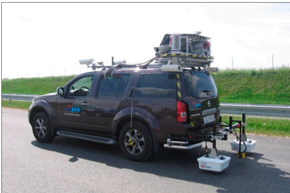
Ryc. 7. Cyfrowa stacja teledetekcyjna wykorzystana do mobilnego kartowania głównych dróg dojazdowych i pożarowych w obrębie Dominikowo. Fot. archiwum GisPro.
